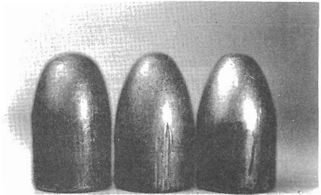
Orientación del rayado en los proyectiles
