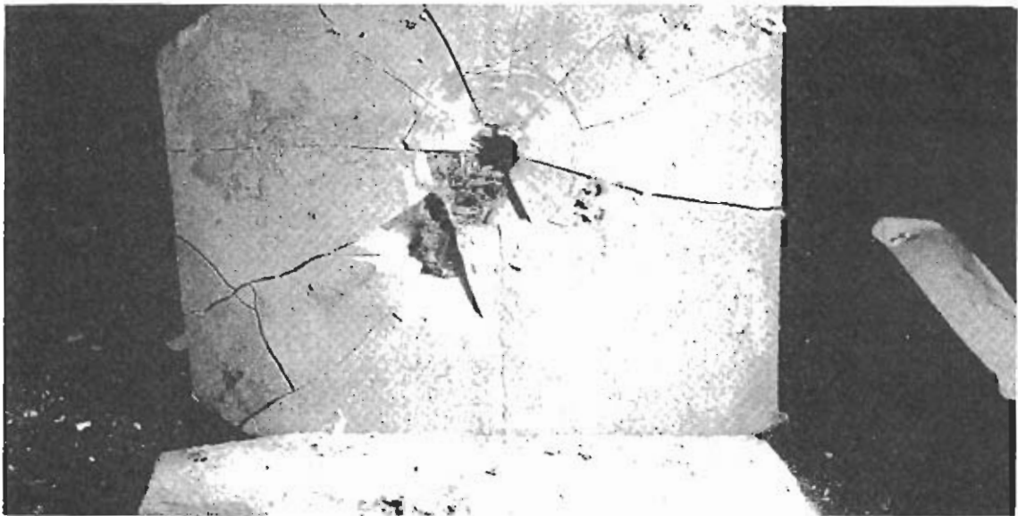
Impacto de un proyectil del calibre 7.62x 63 mm (.30-06) sobre una placa de cerámica del nivel IV
