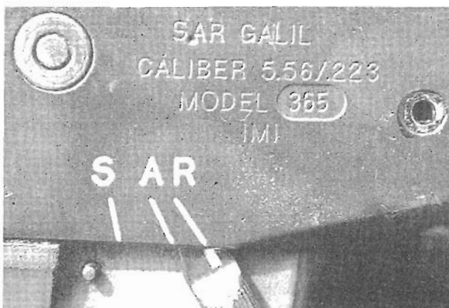
Selector de la cadencia de disparo de un fusil SAR Galil (short automatic rifle)
