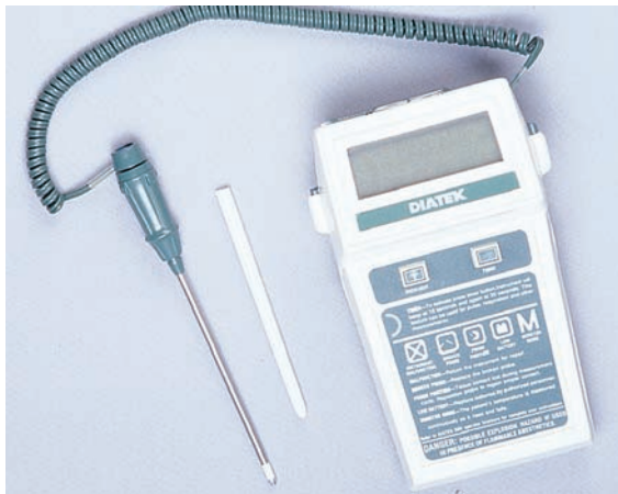
Figura 29-5 ■ Termómetro electrónico. Obsérvese la sonda y la funda de la sonda.
