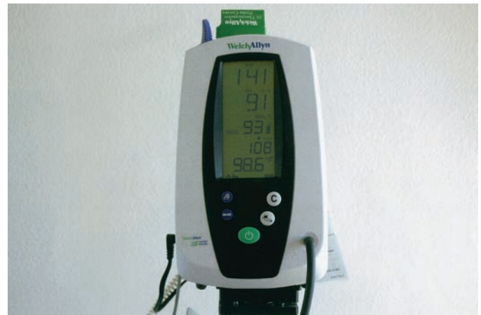
Figura 29-19 ■ Los monitores de presión arterial registran las presiones sistólica y diastólica y, a menudo, otras constantes vitales.
