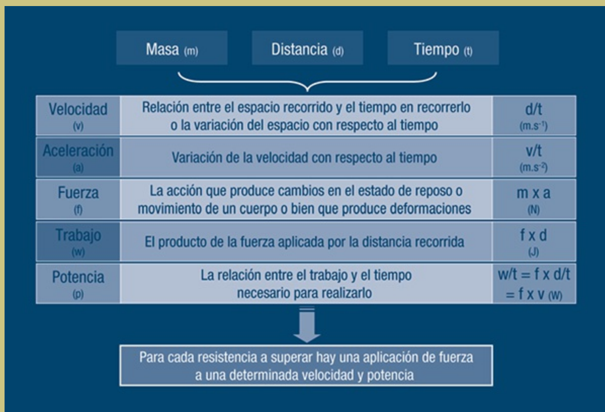
FIGURA 3.1. Concepto y relación de las principales variables mecánicas asociadas a la fuerza. Todas las variables mecánicas utilizadas habitualmente en el entrenamiento de fuerza están interrelacionadas y son dependientes de la masa o de la resistencia a superar, de la distancia y del tiempo.
