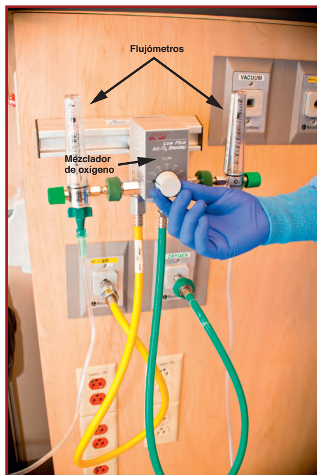
Figura 3.17. Ajustar la concentración y el flujo de oxígeno con aire comprimido (flujo desde la manguera amarilla), oxígeno comprimido (flujo desde la manguera verde), un mezclador de oxígeno y un flujómetro. La imagen muestra 2 medidores de flujo conectados al mezclador de oxígeno. Puede ser que su sistema tenga solo 1 flujómetro.
